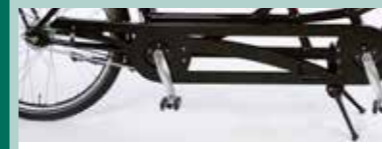
Freewheel crankstel: Het optionele freewheel crankstel geeft de mogelijkheid om onafhankelijk van elkaar te trappen.
